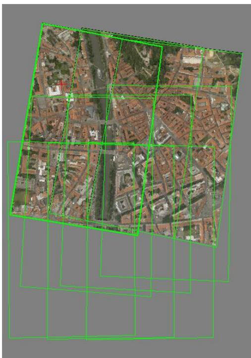
Рисунок 2. Съемка производится длинной стороной поперек маршрута
